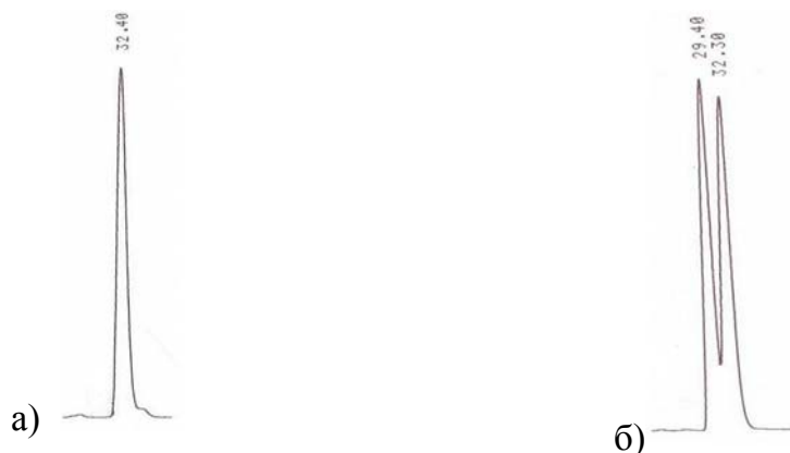
Рис. 3.3. ВЭЖХ хроматограммы метилового эфира N^2, N^6 -дифталоил-( S )-лизина (а) и метилового эфира N^2, N^6 -дифталоил-( R,S )-лизина (б)
